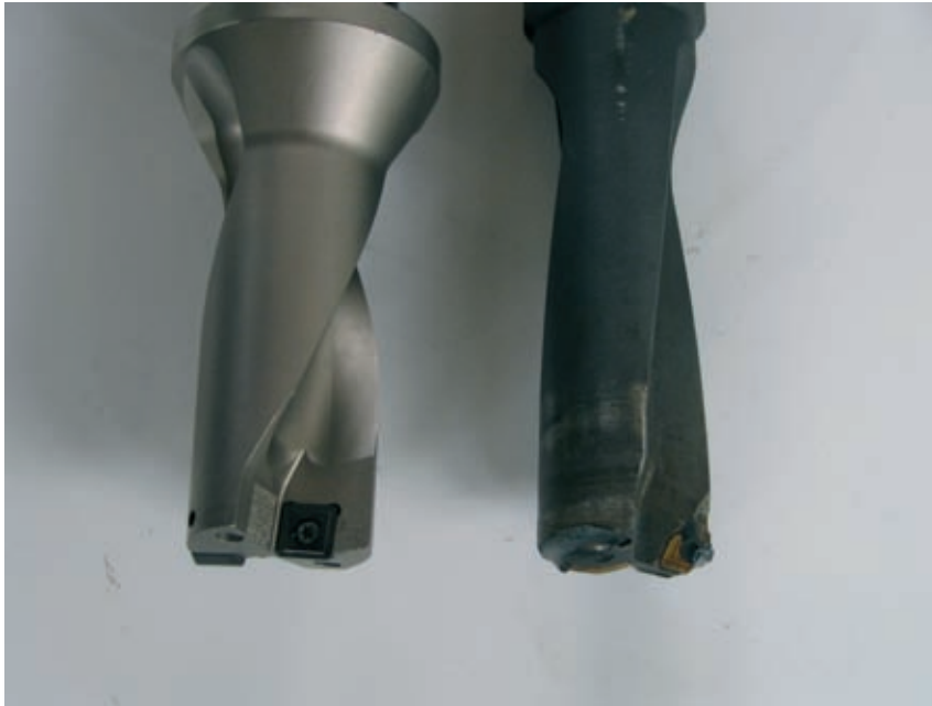
Bild 4: Werkzeugverschleiß und Werkzeugbruch – ein echter Kostenfaktor für Dreherei-Betriebe. Mit ToolGuard werden solche kostspieligen Schäden vermieden (Werkbilder: Saeilo Deutschland GmbH, Wetzlar)
